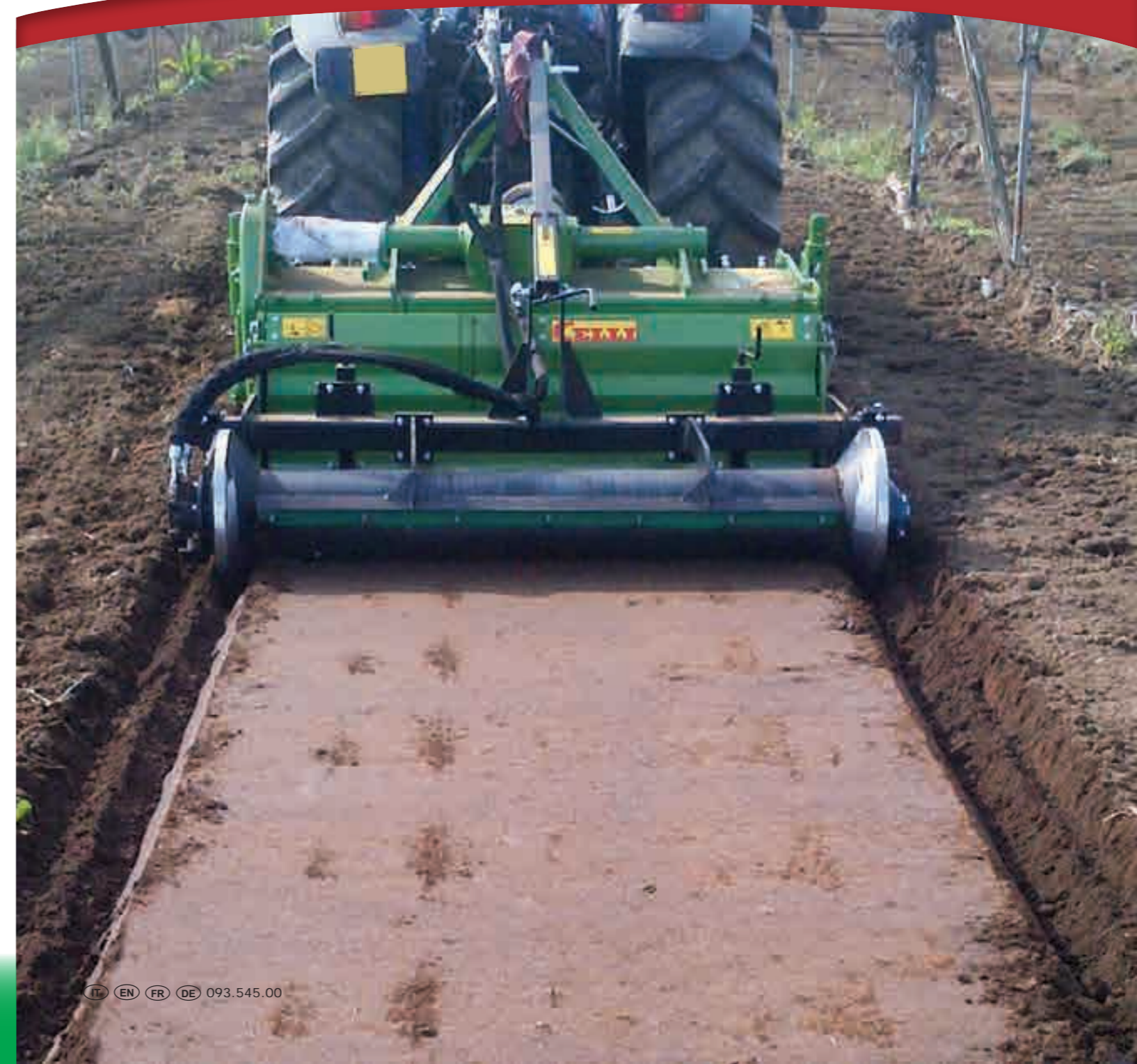
ARES BF con rullo cilindrico baulatore idraulico a richiesta ARES BF with hydraulic roller hydraulic bed former on demand ARES BF avec rouleau hydraulique butteuse hydraulique sur demande ARES BF mit hydraulischer Walze hydraulischer Beetformer auf Anfrage.
